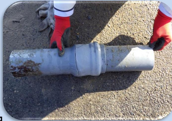
水道管の漏水修理状況／既存管路(老朽化等)
