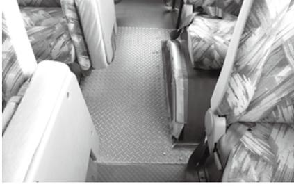
老朽化で床が抜けたため鉄板で補修した車内
